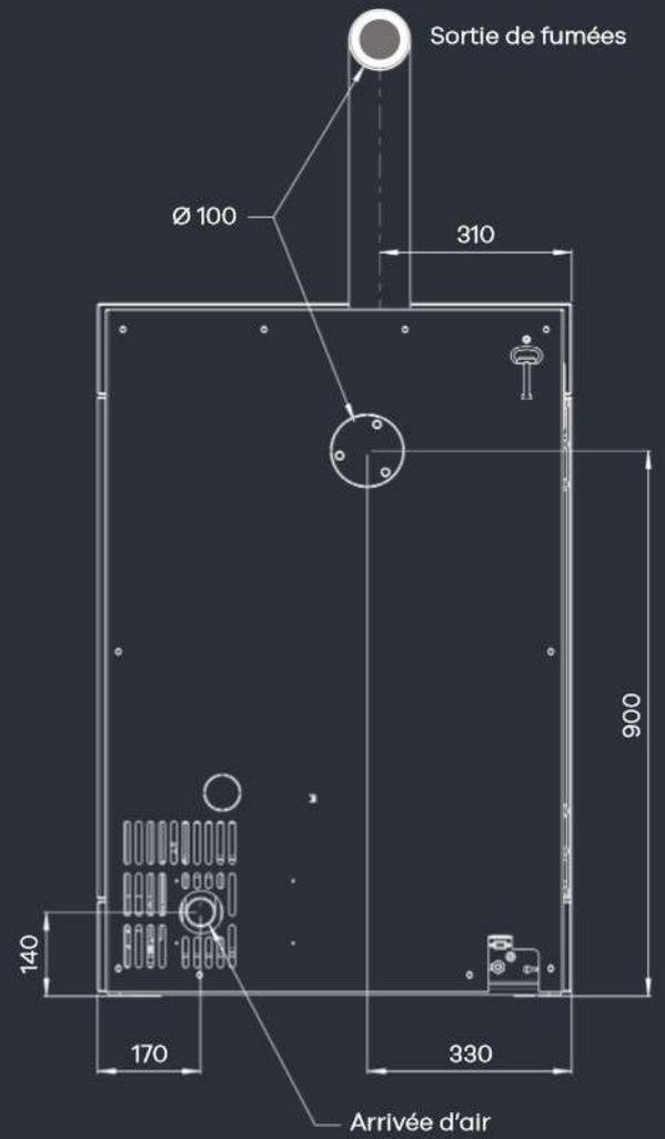
**Version MultiAir.** Permet de transférer de manière canalisée l'air de convection réchauffé dans une deuxième pièce (30 % maxi de la puissance peut être canalisée jusqu'à 5 m).
